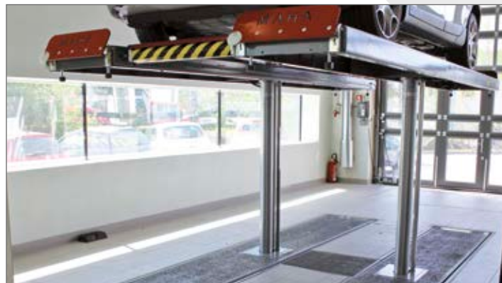
Fahrzeug an den Rädern gehoben
