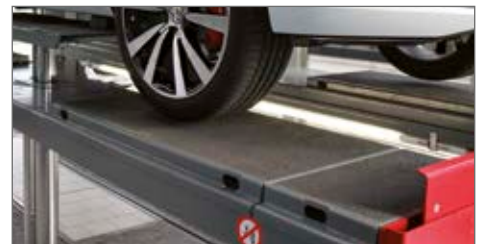
Fahrflächen mit Ausgleichplatten zum Niveaueingleich an den Radfreiheber oder an die Achsvermessung.
