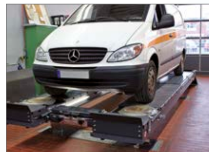
VS SQUARE II 6.5 mit Achsvermessung
