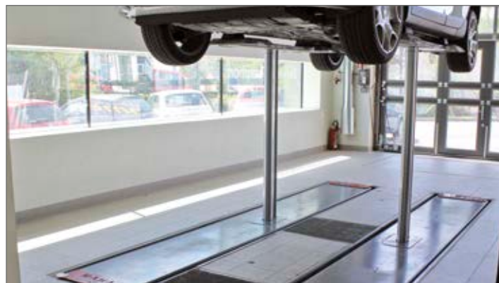
Fahrzeug am Schweller gehoben
