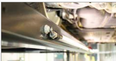
Drehbare LED-Beleuchtung zum einfachen Einstellen der Lichtrichtung, um blendfrei zu sehen.
