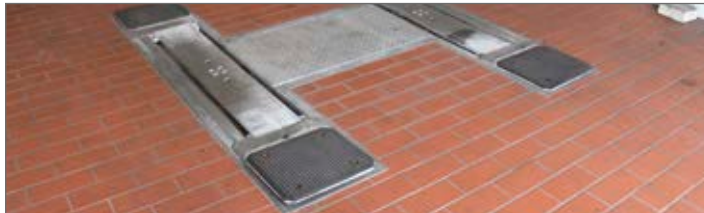
Für leichtes Überfahren der Flachträgeraufnahme. Mithilfe des Einbaurahmens D-ER sowie den geraden Auszügen kann die Flachträger-Hebebühne bodeneben eingebaut werden. Dadurch ist ein schnelles Heben und Senken ohne Verstellen der Auszüge gewährleistet.
