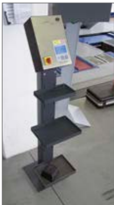
Steuerung auf einer Funktionsstandsäule, zur freien Aufstellung montiert
