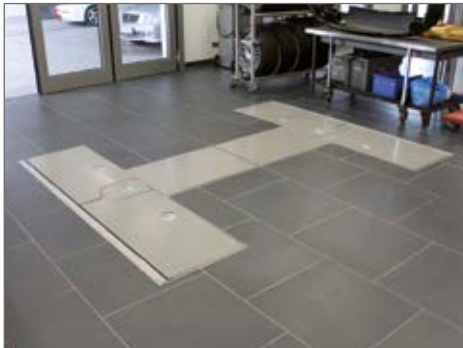
Vollständig abgedeckte Schwenkarmaufnahme mit Radlast 2 t überfahrbar
