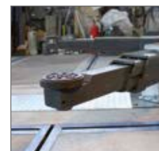
Unterschwenkhöhe am Aufnahmeteller von 123 mm
