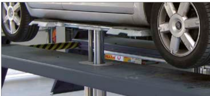
Fahrflächen-Hebebühnen mit Flachträger-Radfreiheber, Schwelleraufnahme Traglast 3,5 t
